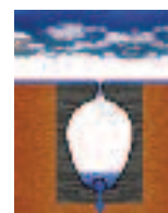
Počátek srážek, žlab se začíná naplňovat vodou, která odtéká regulátorem průtoku.
