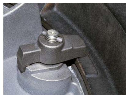
uzamykání pomocí speciálního otočného uzávěru
