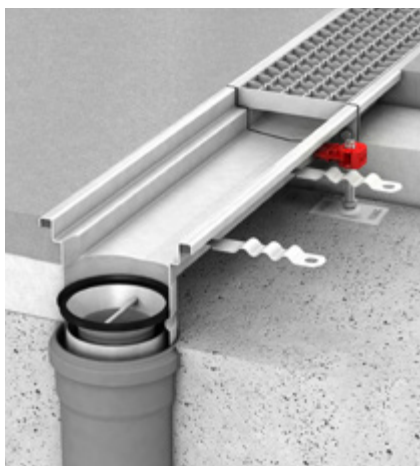
Svislý odtok DN100 vč. sifonu, bez vpusti a napojení hydroizolace (beton)
